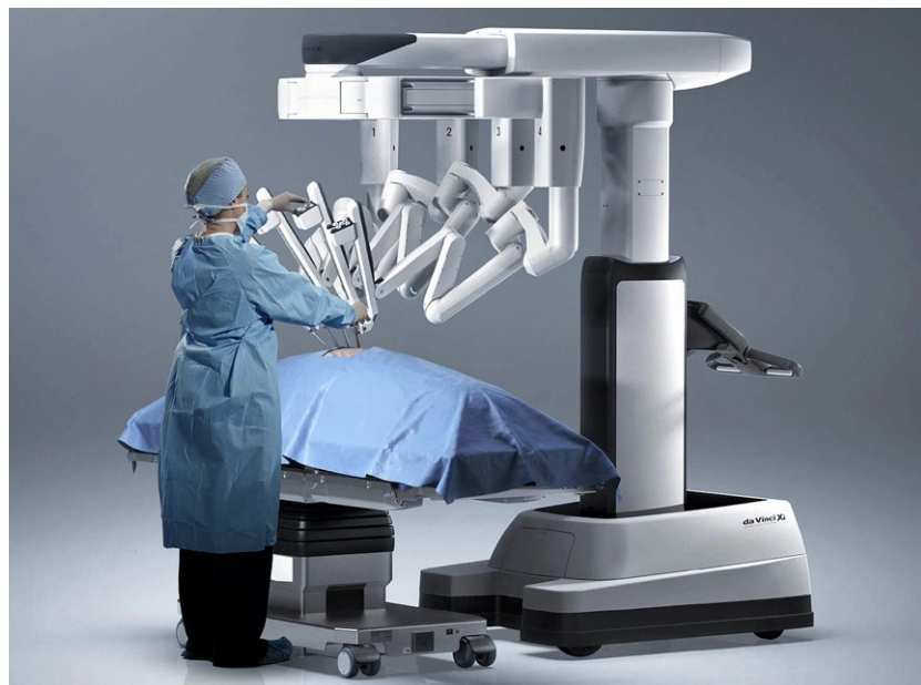
Da Vinci inovativni kirurški operacijski sustav primjer je primjene robotike u kirurgiji
